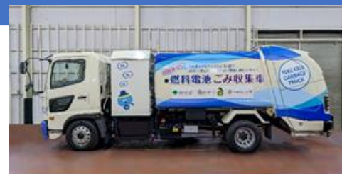
【試験運用】燃料電池ごみ収集車 (多摩市試験運用車両)
