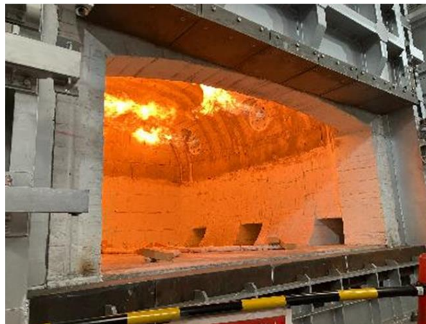
図: 初回の燃焼テストの様子 (都市ガス専焼条件)
