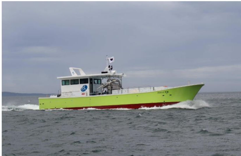
水素燃料電池を搭載した養殖給餌漁船「ZERO-E黒瀬」
