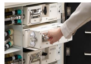
カセット式の水素吸蔵 合金カートリッジ
